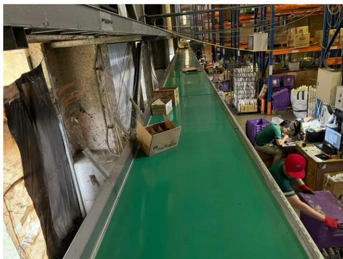
皮帶輸送機是利用連續而具有撓性的輸送帶輸送物料的輸送機。輸送帶繞過滾筒後首尾相接形成環形，由張緊滾筒將其拉緊。驅動裝置使驅動滾筒旋轉，借助滾筒與輸送帶之間的摩擦力使輸送帶運動。
