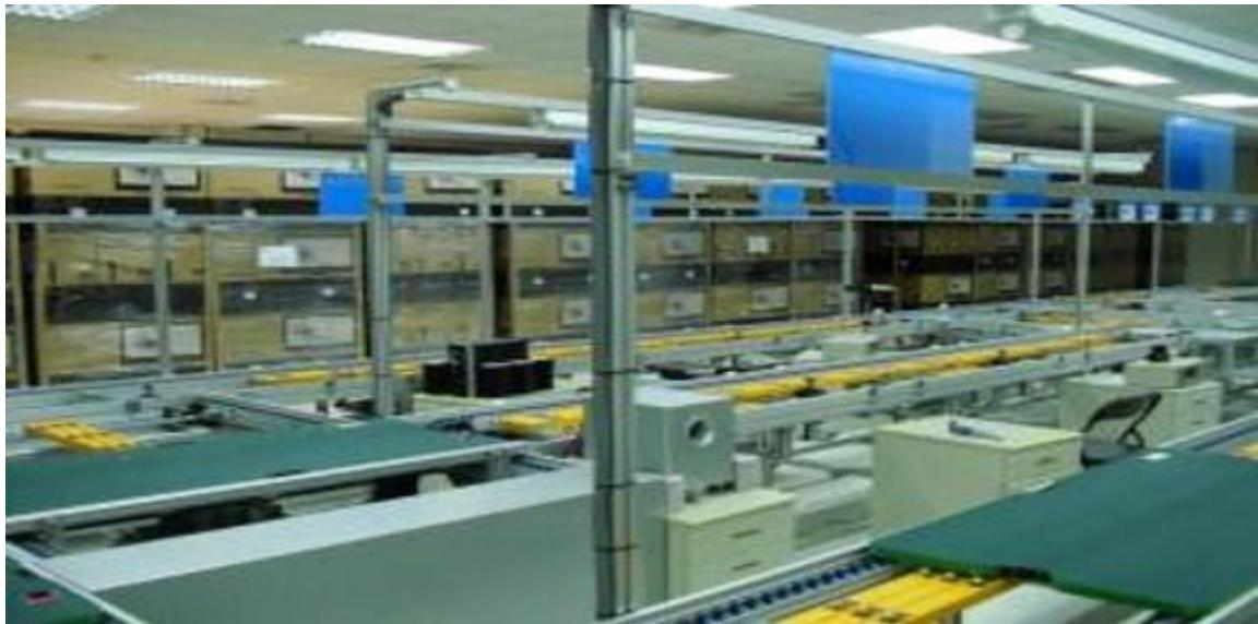
倍速鏈輸送機是利用小輪運轉慣性拖動大輪運轉的方式，使輸送物以2倍的速度前進，如遇STOPPER升起時輸送物則停止前進，鍊條不停，STOPPER放下時則輸送物繼續前進以達到最大生產效能。
